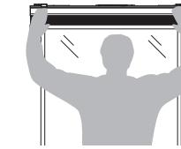
**REMARQUE :** Il est de la responsabilité de l'installateur d'utiliser des fixations de type et de longueur appropriés pour monter l'ensemble des supports. Il devra s'assurer qu'elles sont bien enfoncées dans une structure solide. Ajoutez un élément bloquant sécurisé si nécessaire.
